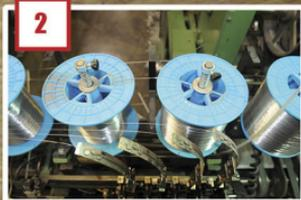
Une bobine de fil pour l'agrafeuse de la machine à assembler de VGR. L'assembleuse met les pages du magazine en ordre, les agrafe et les rogne. Le magazine que tu es en train de lire en ce moment a été agrafé par cette machine.
